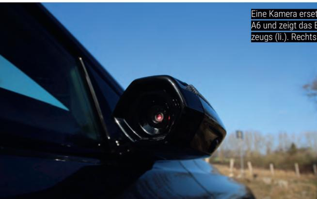
Eine Kamera ersetzt den Außenspiegel des A6 und zeigt das Bild im Inneren des Fahrzeugs (li.). Rechts die Fahrerkonfiguration.
